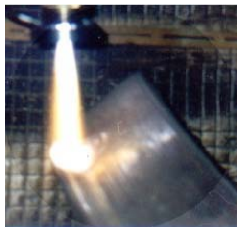
Рис.3. Плазменное поверхностное упрочнение колеса под локомотивом
