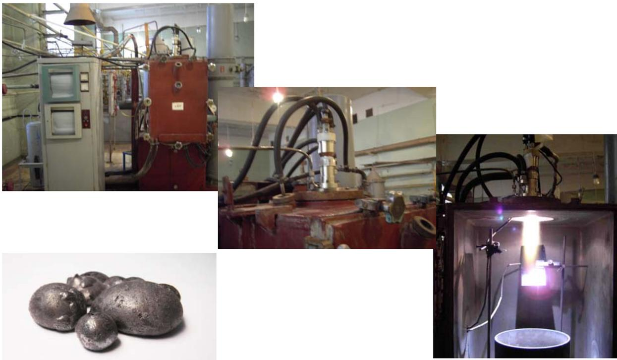
Рис.4. Лабораторная установка мощностью 100 кВт плазменного пиролиза моносилана
