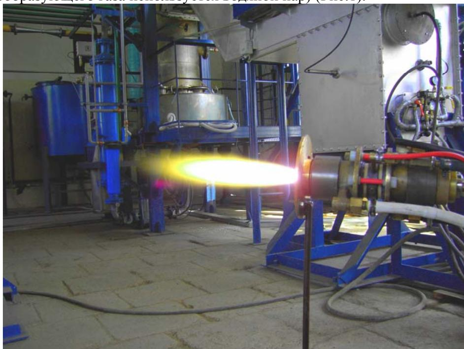
Рис.1. Паровой плазмотрон мощностью 150 кВт в составе пилотной установки для получения синтез газа из твердых органических отходов
