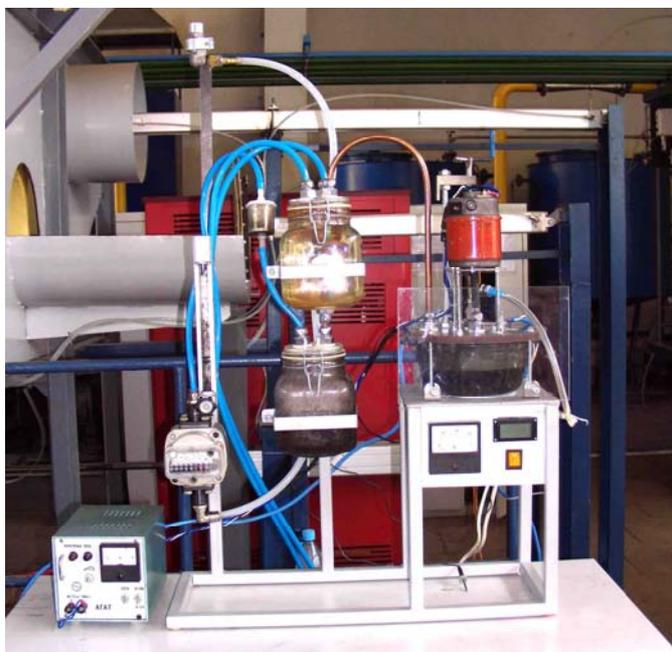
Рис.3. Лабораторная установка плазменно дуговой переработки жидких отходов в синтез газ.
