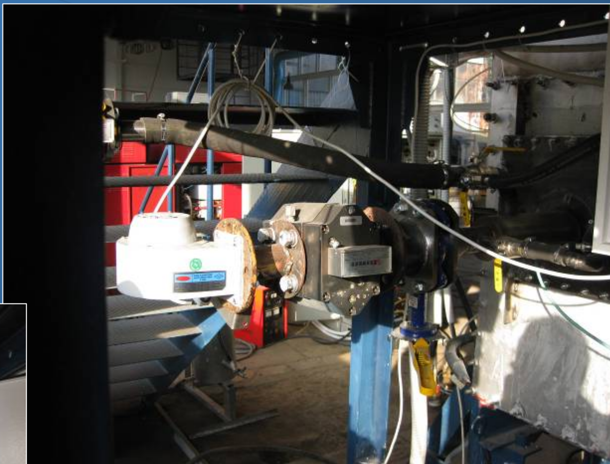
Устройство для газового подогрева камеры лабораторной установки
